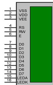
**Fig: 2.1: LCD Display**
